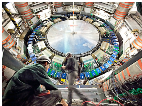
Przenoszenie kalorymetru na stronę A w szybie detektora ATLAS fot. Claudia Marcelloni, 17.01.2011
